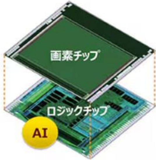
インテリジェントビジョンセンサーの積層構造イメージ
